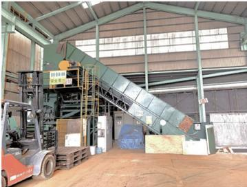
段ボールなどを降ろして機械を動かすと、コンベア部分が自動で上がっていき、
