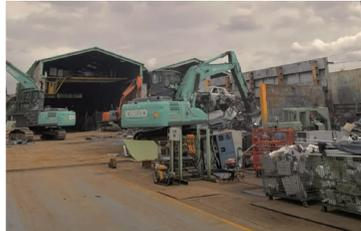
この場所では、手前の計量台で鉄の重さを車ごと量った後、少し進んだ場所でおろして、先端に磁石がついている重機を使い、持ち込まれた鉄の仕分けを行っているそうです。それらは、仕分け後、ギロテンや、ガスを使って細かく切断して、扱いやすい大きさにします。
